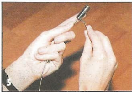
5 Тросик вводят в натяжную втулку и «намертво» зажимают его с помощью ключа с внутренним шестигранником.
