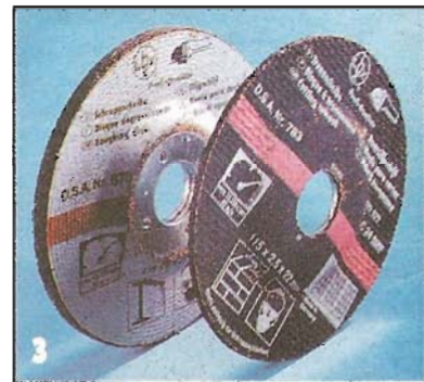
В маркировке круга указаны следующие данные: наружный диаметр — 115 мм, толщина — 2,5 мм, диаметр посадочного отверстия — 22 мм, максимальная скорость вращения — 13330 об/мин, назначение — для обработки металла.
